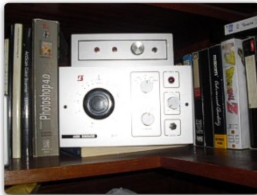
Esto es un aparato electrónico que genera un tono, para ser inyectado en un circuito electrónico y poder ver cómo se comporta.
